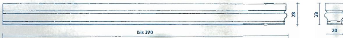
Architrav 1036 mit Endprofil, 28 cm hoch, bis zu 370 cm lang. In gebogener Ausführung 103602
